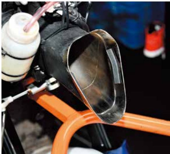
エアダクトの内側にもメッキ加工が施された。ここでも静電気を除電し、空気の流れが整う効果をねらう
